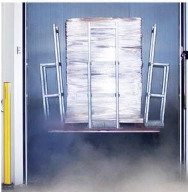
Straßentransport als auch für die Schiff- und Luftfahrt in einer entsprechenden Prüfumgebung untersucht und die Transportverpackung zielgerichtet optimiert werden.
